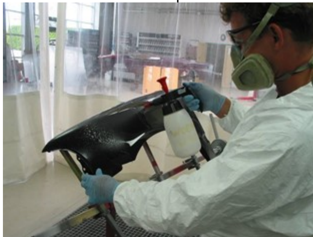
Rys. 3. Nakładanie zmywacza do usuwania silikonu za pomocą zbiornika ciśnieniowego
