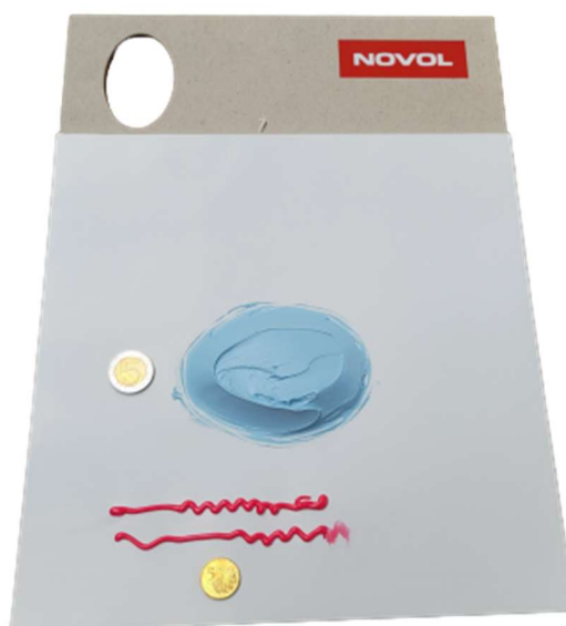
Rys. 2. Wizualne przedstawienie ilości potrzebnego inicjatora reakcji (czerwona pasta) w stosunku do ilości szpachlówki (na przykładzie 50 gramów szpachlówki i 1,5 grama utwardzacza) [źródło: NOVOL]
