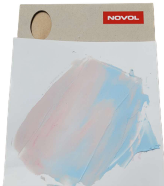
Rys. 4. Nieprawidłowego wymieszania szpachlówki z inicjatorem w układzie ze wskaźnikiem mieszania [źródło: NOVOL]
